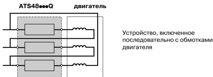
**Примечание:** настройки номинального тока и тока ограничения, а также ток, отображаемый при работе, остаются выраженными в значениях линейного тока, что дает возможность пользователю не прибегать к вычислениям.
